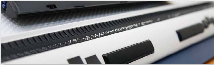
Braillezeile: Der Text wird in Punkschrift angezeigt
